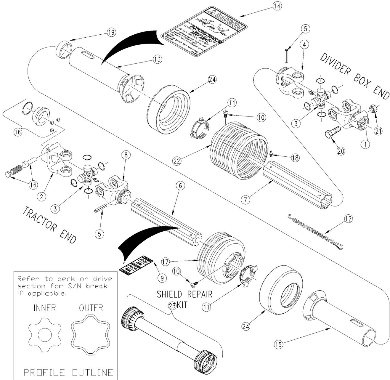
**Driveline Conv. 540 RPM (826-112C) Walterscheid****Applies to RC4620**
